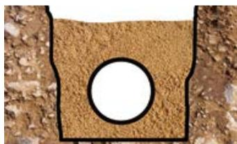
Gli inerti di contorno alla tubazione sono funzionali a garantire una più corretta e omogenea compattazione, oltre a escludere la presenza di carichi puntuali.
