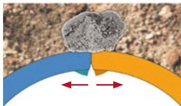
CON IL TEST IN OGGETTO VIENE SIMULATO L'EFFETTO DI UN CARICO PUNTUALE SULLA TUBAZIONE PE IN ESERCIZIO CON PRESSIONE.
