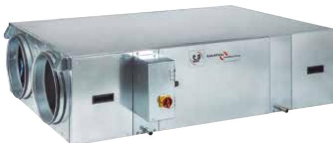
Recuperatore di calore, con scambiatore del tipo a flussi in controcorrente ad alta efficienza (fino all'88%) certificato EUROVENT, montato in una cassa di acciaio zincato, con isolamento interno termoacustico ignifugo (A1/M0) in lana minerale SP. 25 mm per i modelli da 500 a 2500 e 30 mm per i modelli 2500 a 4500.
