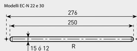
È necessario realizzare 1 asola (R) da 250x15 o 12 mm. Successivamente è necessario fissare la presa d'aria ai 2 punti di fissaggio.
