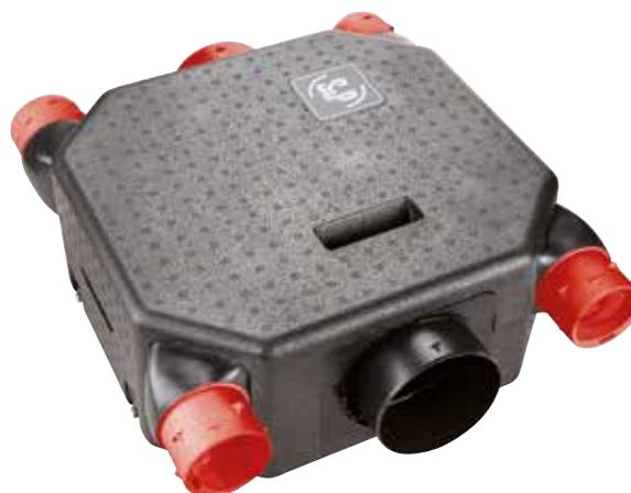
Gruppo VMC autoregolabile, di basso profilo e di basso livello sonoro, che assicura il rinnovo permanente dell'aria nelle abitazioni. Il sistema si completa con degli ingressi aria autoregolabili nelle stanze principali dell'abitazione (sala e camere) e con delle bocchette di estrazione autoregolabili nelle stanze umide (bagni e cucina).
