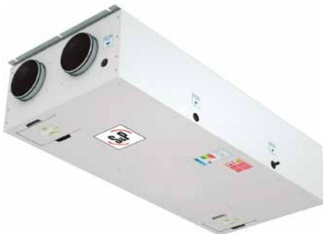
Recuperatore di calore a doppio flusso per abitazioni, con scambiatore di calore in controcorrente che garantisce un'efficienza fino all'85% assicurando un continuo rinnovo dell'aria.
