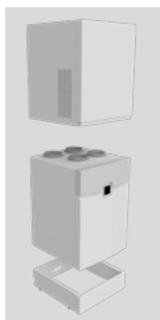
Moduli di accoppiamento ad innesto rapido con basamento dotato di piedini regolabili in altezza.
