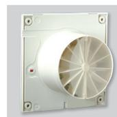
**Serranda di non ritorno** previene l'ingresso dell'aria e la dispersione di calore quando l'estrattore non è in funzione. La serranda si apre per la pressione dell'aria.
