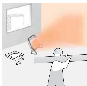
Asciugatura di parete in costruzione.
