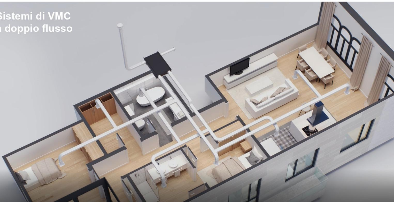
Il doppio flusso è il sistema di ventilazione meccanica con la maggiore efficienza energetica, isolamento acustico, comfort e filtrazione dell'inquinamento esterno.
