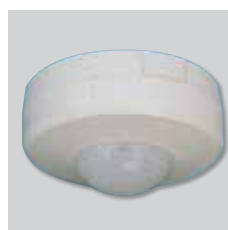
CPFL-S / CPFL-E Rilevatori di presenza CPFL-S per installazione a parete. CPFL-E per installazione ad incasso. Sensibili ai raggi infrarossi dovuti al calore che emettono i corpi in movimento con un angolo di rilevamento di 360°.
