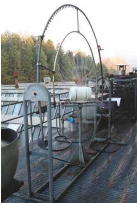
Invecchiamento del prodotto esposto alle intemperie
