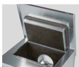
Basso livello sonoro Isolamento fonoassorbente sp. 50 mm (M0) in fibra di vetro ad alta densità che riduce significativamente il rumore.
