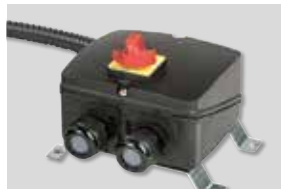
Scatola morsetti esterna IP65 Scatola morsetti esterna fabbricata in materiale plastico ignifugo V0 con interruttore di marcia incorporato.
