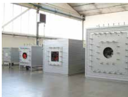
Tunnel aerodinamici per determinare le prestazioni di portata-pressione dei ventilatori.
