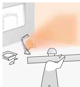
Asciugatura di parete in costruzione.
