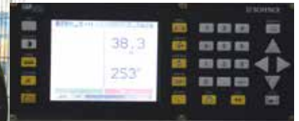
Equilibratura delle giranti
