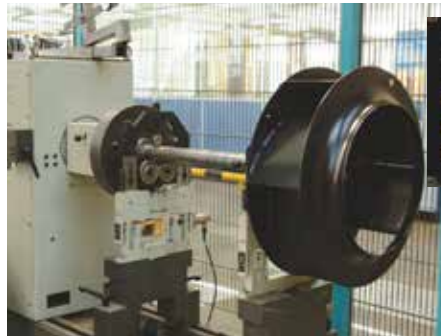
Equilibratura delle giranti
