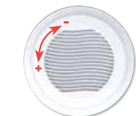
Apertura (+) o chiusura (-) dell'otturatore (posizione di chiusura, 1 o 2)
