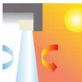
Nel periodo estivo, l'aria calda non entra nei locali climatizzati.
