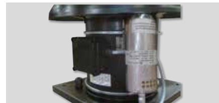
Condensatore speciale ATEX
