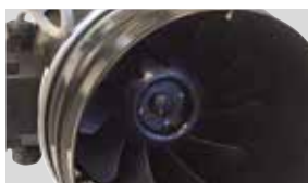
Girante elicocentrifuga Girante elicocentrifuga ad alto rendimento.
