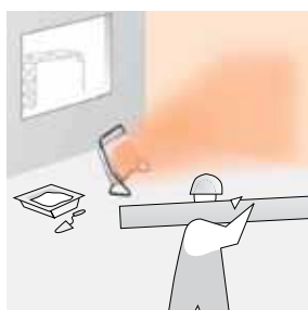
Asciugatura di parete in costruzione.
