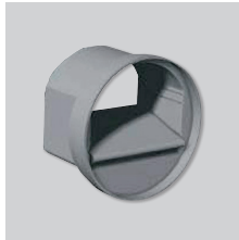
RD BP Regolatori di portata autoregolabili di bassa pressione. (20/100 PA) Per installazione a condotto. Diametro 80 mm. Portata: 15 o 30 m 3 /h.
