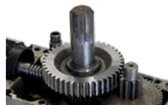
Ingranaggi completamente metallici a 3 livelli di riduzione
