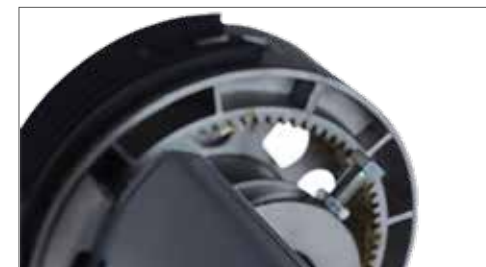
Costruzione robusta con catena di ingranaggi
