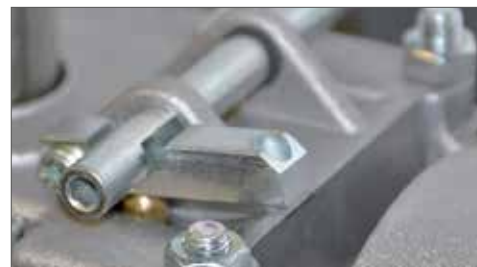
Sblocco esterno anche tramite cordino metallico
