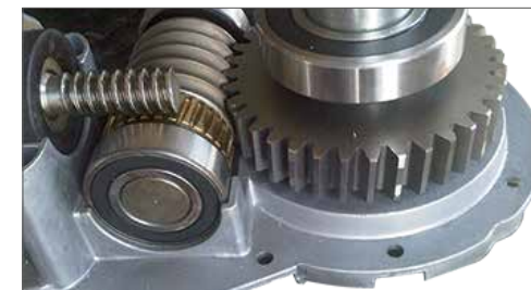
Ingranaggi completamente metallici
