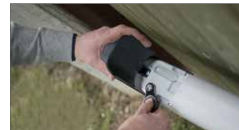
Sblocco manuale con trasmettitore
