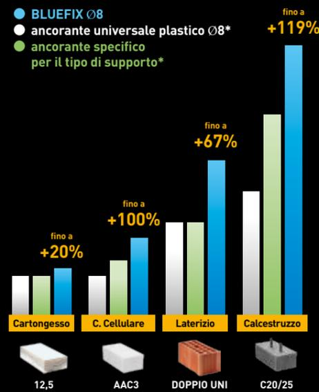
\*Ancoranti attualmente disponibili sul mercato. Coefficiente di sicurezza adottato in tutte le comparazioni, per tutti i prodotti, = 5. Bluefix testato con vite tipo truciolare Ø5.
