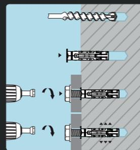
PER LA POSA RAPIDA, SI RACCOMANDA IL SERRAGGIO CON AVVITATORE
