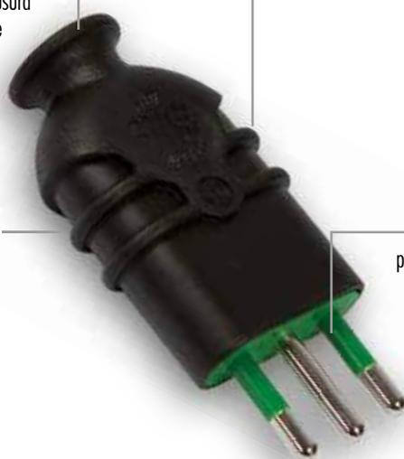
Cablaggio facilitato dalla posizione assiale delle viti che evita anche di scivolare sulla mano con l'utensile. Accetta cavi sino al 3G2,5 in PVC e 3G1,5 in cavo Neoprene H07RN-F.
