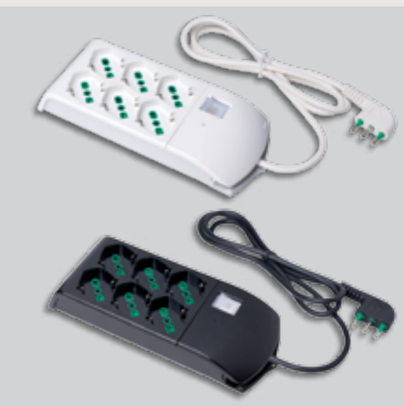
Multipresa a 3+3 uscite Bipasso/St. Tedesco cavo 1,5m 3G1 H05VV-F spina a squadra italiana 2P+T 16A S17 interruttore bipolare luminoso + protezione sovratensioni
