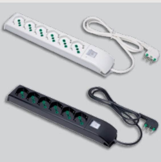
Multipresa a 6 uscite 2P+T 16A Bipasso/St. Tedesco cavo 1,5m 3G1 H05VV-F spina a squadra italiana 2P+T 16A S17 interruttore bipolare luminoso + protezione sovratensioni
