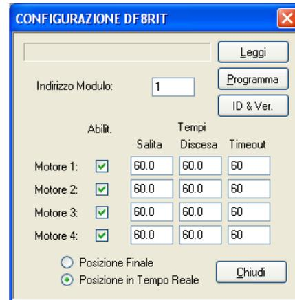
Inserire nella relativa casella l'indirizzo del modulo DF8RIT che si vuole configurare (o leggere), poi togliere il segno di spunta alle uscite non utilizzate come comando tapparella. Nella sezione Tempi si devono inserire i tempi esatti misurati per compiere una intera salita e una intera discesa, per tutti i motori collegati al modulo. Il valore massimo dei tempi di salita e discesa è 127.5 secondi (poco più di 2 minuti) con risoluzione di 0.5 secondi.
