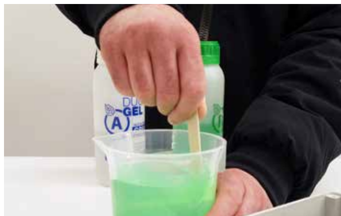
Mescolare la soluzione bicomponente nell'apposito becher. Mix the bi-component solution in the dedicated beaker.
